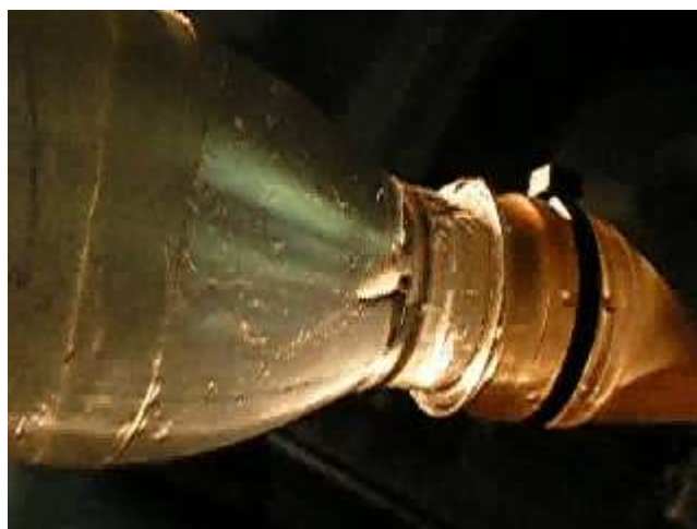
Рис. 9. Визуализация течения в зоне установки оптимизированного ИКС.
